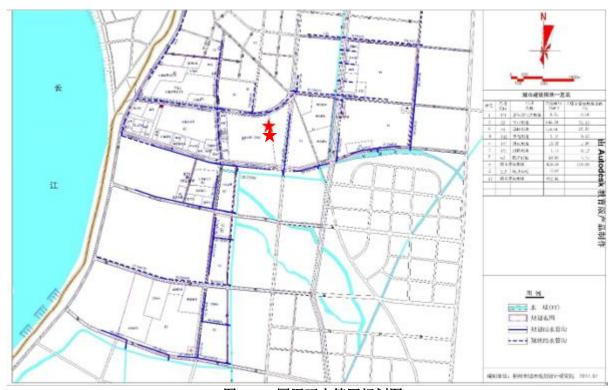
图 7.7-9 园区雨水管网规划图
